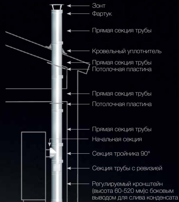
Внутренний монтаж сзади
