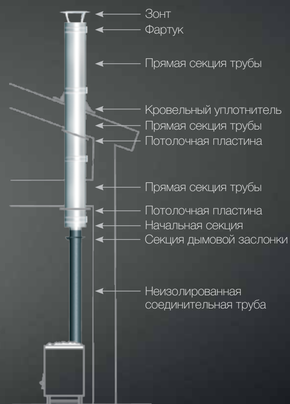
Монтаж с неизолированной соединительной трубой
