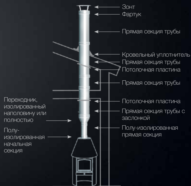
Монтаж сверху камина с полу-изолированной начальной секцией
